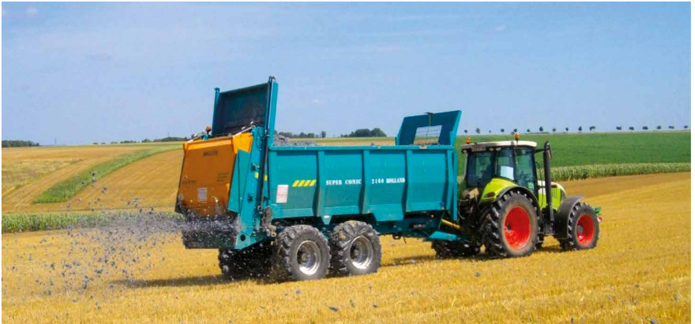
Camion d'épandage des boues.
